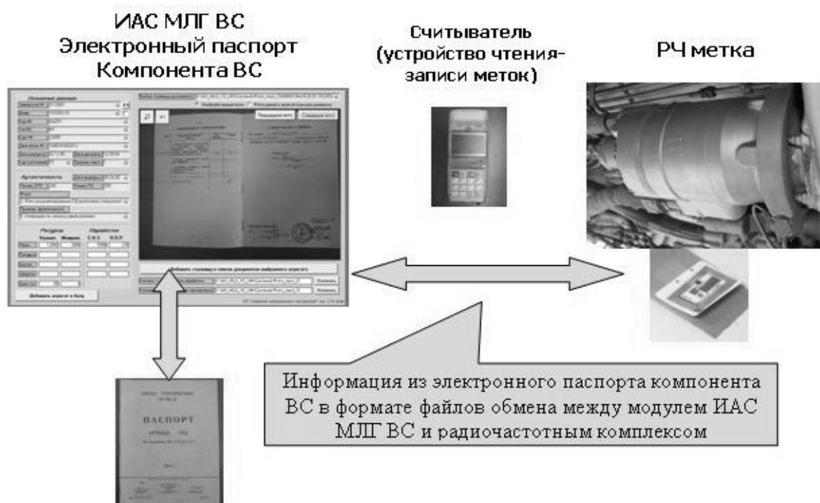
Рис.3. Рабочая модель интерфейса взаимодействия пользовательских модулей ИАС МЛГ ВС и комплексом средств радиочастотной (RF) идентификации.
